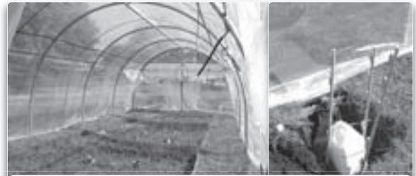
Figura 1. Micro parcelas experimentales para la estimación de residuos de fitosanitarios en agua de escurrimiento. Izquierda vista de la parcela. Derecha, detalle del dispositivo para colecta de agua.
